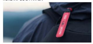
Der RECCO Rettungsreflektor wird direkt von den Herstellern in die Kleidung oder Ausrüstung integriert oder ist als Reflektor zum Nachrüsten für Rucksäcke und Helme erhältlich. Der Reflektor ist ein passiver Transponder und benötigt keinen Strom oder Aktivierung, durch Frequenzverdoppelung "reflektiert" der Reflektor das Suchsignals der RECCO Detekotren und kann dadurch lokalisiert werden
